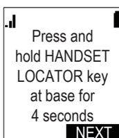
Drücken Sie auf die Funktionstaste unter **NÄCHST** (next), um den Rest der Aufforderung, d.h., die Rautetaste # auf dem Mobilteil zu drücken, anzuzeigen.
