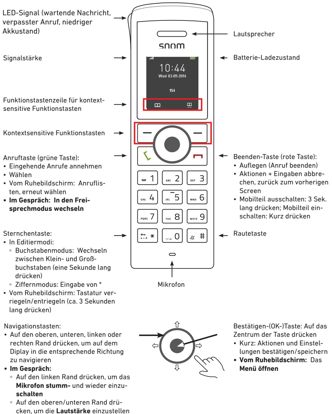
**Hinweis:** Das M25 hat zwei kontext-sensitive Funktionstasten (Softkeys) unter dem Display. Alle Display-Screenshots in dieser Anleitung wurden mit dem M65-Mobilteil gemacht, das drei kontext-sensitive Funktionstasten hat. In den wenigen Fällen, in denen auf dem M25 eine Funktion nicht über eine kontext-sensitive Taste zur Verfügung steht, wird die abweichende Bedienung in dieser Anleitung erläutert.
