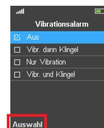
Die Voreinstellung ist "aus". Zur Änderung der Einstellung scrollen Sie mit der Navigationstaste zu einer anderen. Drücken Sie auf die Funktionstaste unter "Auswahl", um die Einstellung zu speichern und zum vorherigen Bildschirm zurückzukehren.
