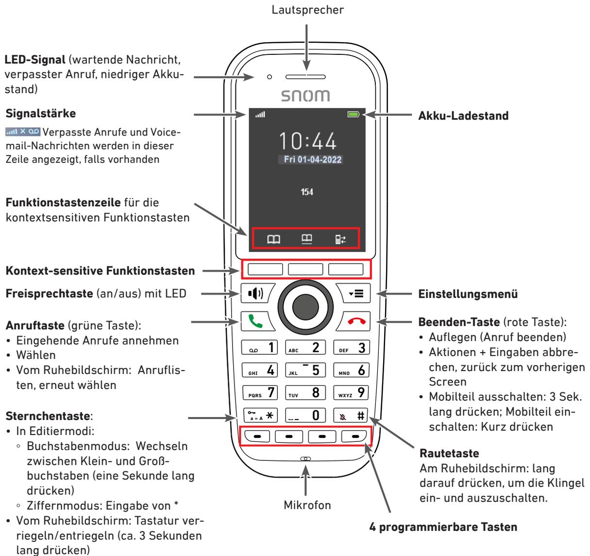
**Navigationstasten:** Auf den oberen, unteren, linken oder rechten Rand drücken, um auf dem Display in die entsprechende Richtung zu navigieren
