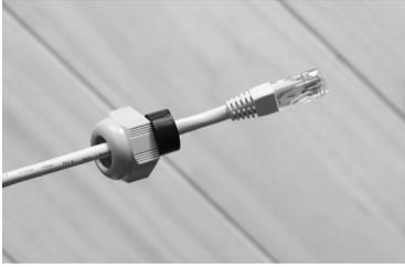
6. Schieben Sie das PoE-Kabel durch die Gehäusebuchse und stöpseln Sie den RJ45-Stecker in die RJ45-Buchse der Basisstation.
