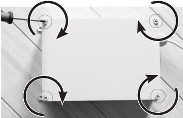
10. Zur optimalen Funkausleuchtung bringen Sie die Basisstation so hoch wie möglich an einer Wand oder einem Pfeiler an (Schrauben und Dübel sind nicht im Lieferumfang enthalten).
